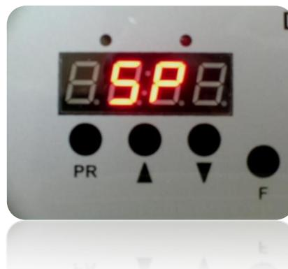
Acione a Tecla PR novamente e surgirá piscando na Tela a Temperatura que deverá ser ajustada para resfriamento da placa.
