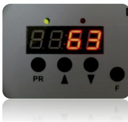
Acione novamente a tecla **PR** e mantenha acionada por 5 segundos para confirmar o valor ajustado. Em seguida aparecerá na tela a mensagem SP e posteriormente a Temperatura atual na Placa de alumínio.
