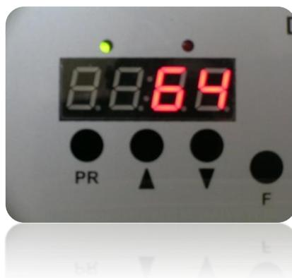
Acione a tecla ▲ para diminuir o valor da temperatura na Placa de alumínio.
