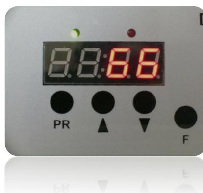
Acione novamente a tecla **PR** e mantenha acionada por 5 segundos para confirmar o valor ajustado. Em seguida aparecerá na tela a mensagem SP e posteriormente a Temperatura atual interna da Cuba.
